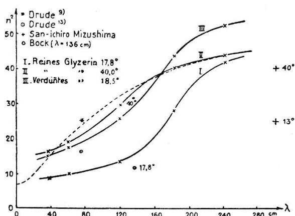
indique l'allure du phénomène à une température plus élevée (40°). La courbe III donne le résultat obtenu après dilution de la glycérine avec de l'eau jusqu'à une teneur de 88 % de
