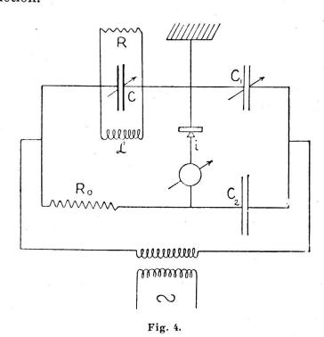
En faisant varier C et C<sub>1</sub>, on peut obtenir la résonance et ramener le courant du pont à zéro. On aura alors:
