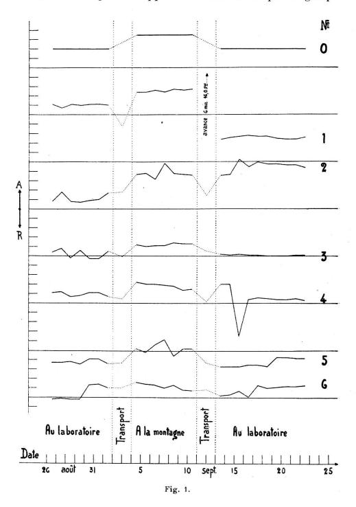
suivant l'expression des horlogers; dans certaines circonstances, si l'échappement à détente n'est pas muni d'un dispositif spécial, il peut se produire deux impulsions pendant la même demi-oscillation, ce qui produit une avance, correspondant bien à ce que nous avons enregistré. Qui eût vu le pauvre instru-
