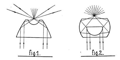
appareils les plus modernes et les plus répandus, comme, par exemple, le condensateur paraboloïde de Siedentopf. Dans le modèle de Nachet (fig. 2), la lumière est concentrée au niveau de l'objet, sur une surface de très faible étendue, après double réflexion sur miroir convexe et sur miroir concave.
