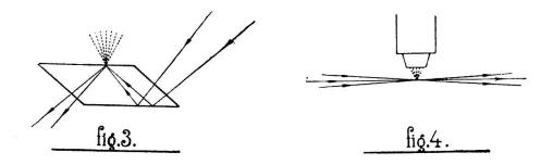
Cotton et Mouton<sup>2</sup> ont employé pour leurs recherches sur les colloïdes un dispositif différent (fig. 3), constitué par un bloc de verre prismatique sur deux faces duquel la lumière incidente subit la réflexion totale; ceci se produit notamment sur la face qui porte la préparation à examiner. Remarquons que, dans tous ces systèmes, l'objet est, en définitive, éclairé obliquement, de bas en haut.
