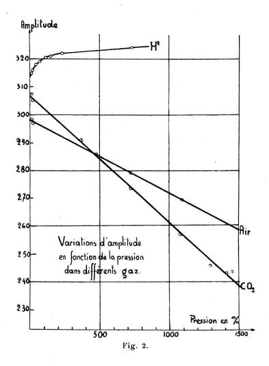
la viscosité de l'anhydride carbonique est notablement plus faible que celle de l'air, tandis que l'inverse a lieu, sous une même pression, pour les densités.
