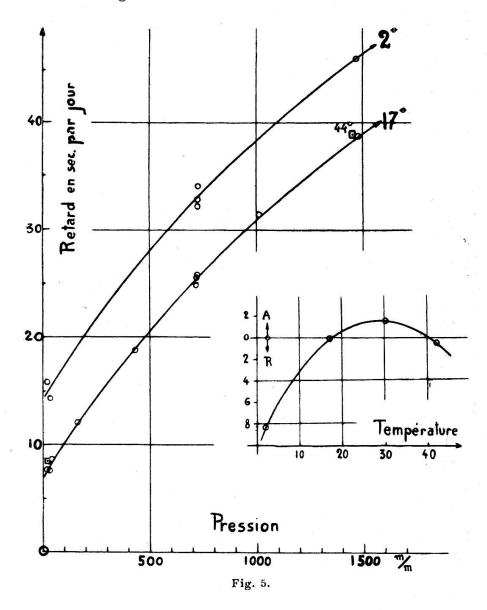
La figure 5 montre le résultat; la courbe à 44° n'a pas été tracée, étant trop voisine de celle à 17°; d'ailleurs deux points seulement ont été obtenus, ce qui a paru suffisant; ces points sont, sur la fig. 5, entourés d'un carré. On remarque que les
