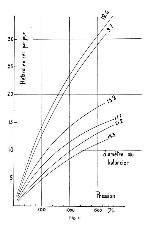
mais nous retrouverons une anomalie semblable en parlant des balanciers de révolution. Une autre exception existe dans l'intervention des courbes relatives aux balanciers de 12,6 et 9,7 mm.
