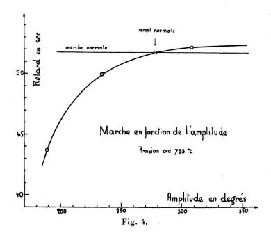
J'ai opéré pour quatre amplitudes différentes; les résultats sont reportés sur le graphique de la figure 4. On voit que la diminution d'amplitude produit une avance, d'abord très faible, puis de plus en plus prononcée.
