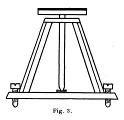
Si l'on pose la montre en marche sur cet appareil, elle effectue des oscillations forcées. La différence de phase est encore voisine de  $\pi$  et provoque une avance. Comme l'amplitude des oscillations est faible, cette avance, dans les cas étudiés, est de l'ordre de 30 secondes par jour. Elle fournit donc la valeur de T pour  $T' = \infty$ .
