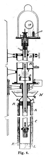
était solidement fixé à un mur extérieur afin d'éviter les trépidations pouvant perturber nos mesures. Dans quelques-unes de nos expériences, nous avons observé que le zéro se déplaçait de 5 à 10 mm lorsque nous faisions le vide dans l'appareil. Nous attribuons ces variations à de légères déformations du tube inférieur, déformations paraissant dues aux variations de pression. Dans ce cas, nous avons attendu, avant de faire les mesures, que le zéro ait pris une position invariable.
