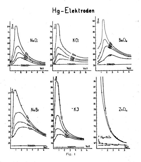
tensions plus faible. Les conditions ressortent des diagrammes. Ce phénomène disparaît complètement pour les hautes fréquences. La position du maximum dépend en outre de la présence des anions et des cations.
