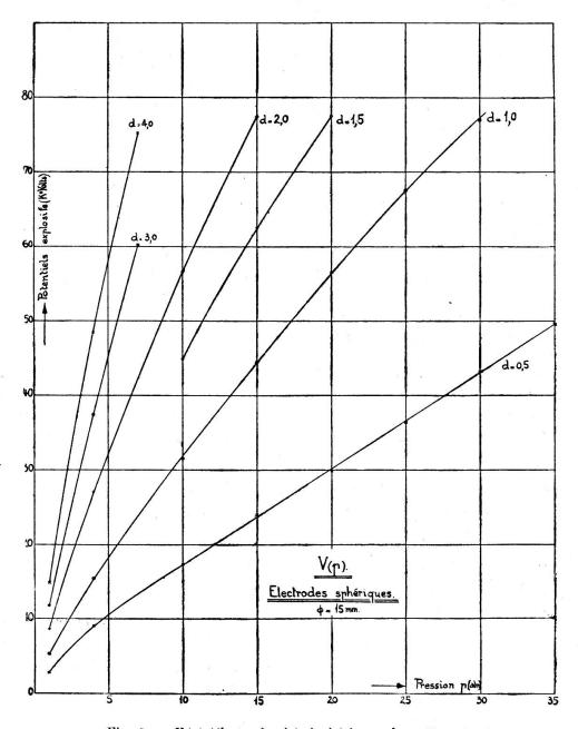
Fig. 5. — V(p) (électrodes hémisphériques  $\Phi = 15$  mm).
