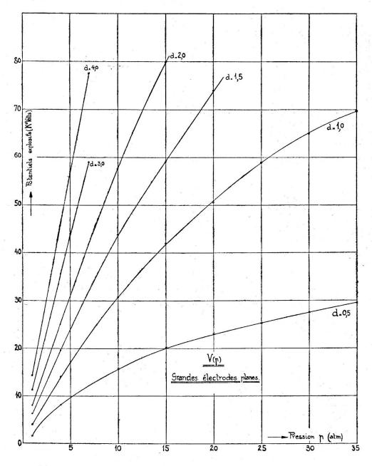
Fig. 6. — V (p) (électrodes planes  $\Phi = 45$  mm).
