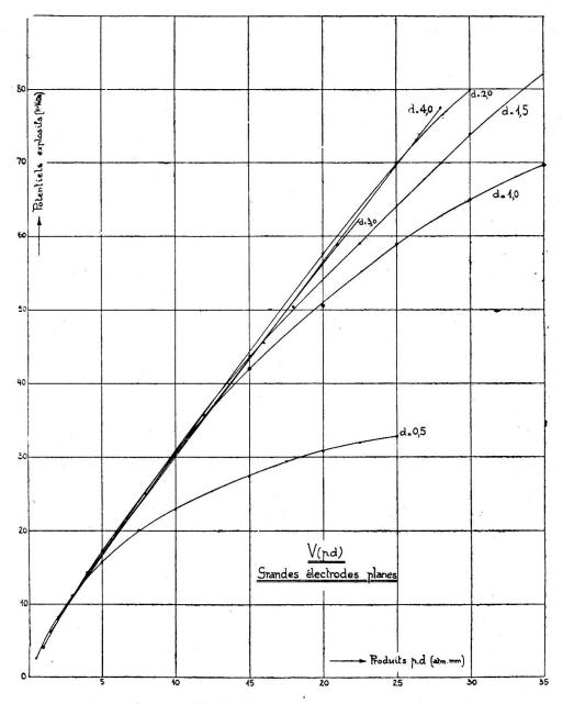
Fig. 9. — V(pd) (électrodes planes  $\Phi = 45$  mm).
