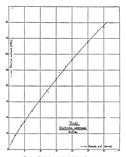
Fig. 7. — V (pd) (électrodes hémisphériques  $\Phi = 15$  mm).
