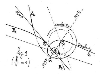
La figure (1) fixe la position relative des plans  $\Pi_1$  et  $\Pi_2$  l'un par rapport à l'autre, pour la valeur  $\pi$  de  $\omega$ ; la branche  $B_2$  a roulé sur la branche  $B_1$ ; puis la branche spirale  $S_2$  roule sur la spirale  $S_1$ .
