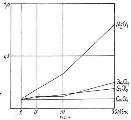
Courbes d'absorption de MgCl<sub>2</sub>, BaCl<sub>2</sub>, SrCl<sub>2</sub>, et CaCl<sub>2</sub> (Lupinus albus).
