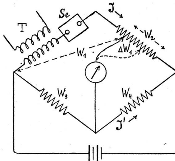
On peut calculer quelle grandeur doit avoir  $\Delta W_1$  pour qu'à  $P$  s'ajoute la tension effective  $V$ . Nous supposerons du sinusoïdal ( $V_0 \sin \omega t$ ) et que  $V_0 < P$  à cause de la validité de (1). Soit  $i$  la composante continue qui traverse la cellule. Par suite de l'effet en question, il se produit une tension  $W_p i$  aux bornes de la cellule,
