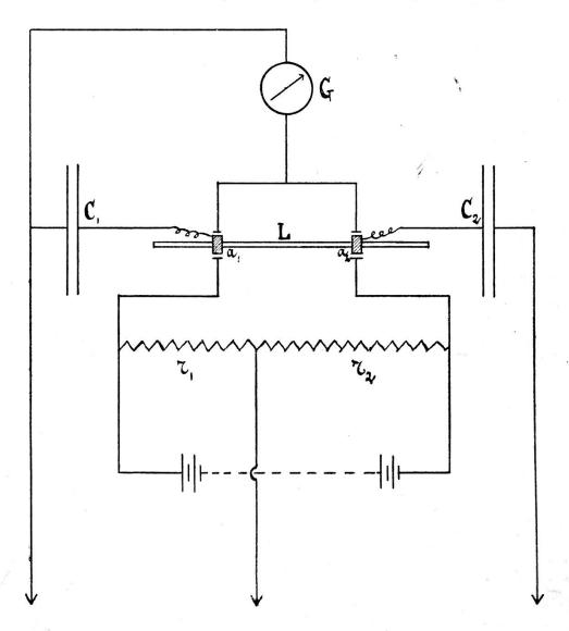
à celle du galvanomètre. Souvent, au lieu de mesurer le courant i on l'annule au moyen d'un courant de sens inverse et de même intensité fourni par un potentiomètre. La méthode devient ainsi une méthode de zéro; et si la pile du potentiomètre sert en même temps à la charge du condensateur, on est indépendant des variations de sa force électro motrice. Mais il est alors nécessaire que la clé vibrante ou le commutateur tournant ait une période rigoureusement constante, ce qui n'est pas facile.
