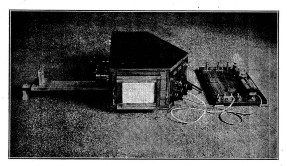
enregistrées. La durée d'oscillation propre de la boucle est variable et peut être abaissée jusqu'à 1/1500° de seconde environ. Dans le voisinage de 1/900° de seconde, on obtient sur le verre dépoli de l'appareil une déviation de 1 cm. avec un courant continu de 0.48 ampère; en projetant sur un grand écran, on a une déviation proportionnellement plus grande.
