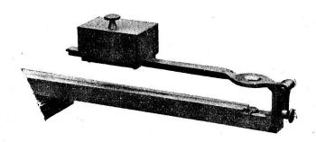
Une barre d'invar, à la face supérieure de laquelle on a pratiqué une rainure longitudinale, est munie, à ses extrémités, de deux armatures, dont l'une sert de butoir, tandis que l'autre soutient l'axe du levier coudé assurant la tension du fil. Les extrémités de celui-ci sont munies d'écrous qui appuient sur l'armature et sur le petit bras du levier. Les tracés sont pratiqués sur des pastilles d'invar, serrées par des vis sur le fil, qui les traverse.
