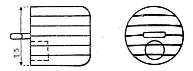
Fig. 29. — Aspect du corps en fer électrolytique obtenu par juxtaposition d'éléments de 5 mm.
