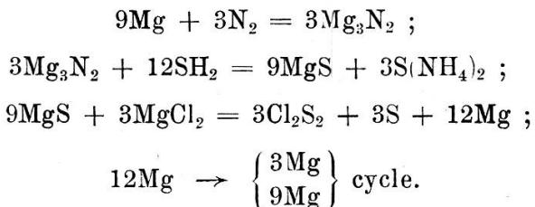
La formation du chlorure de soufre est immédiate, et ce composé est condensé de suite à la sortie du bain électrolytique. Comme il n'a aucune action sur le magnésium, le diaphragme est inutile et le rendement est bon.
