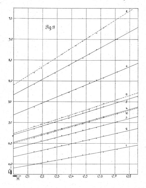
Les valeurs numériques se trouvent dans le tableau VIII et les droites dans la fig. 17. Les droites 1 à 7 ont été prises en chauffant et 8 à 10 en refroidissant. Comme on le voit les points obtenus permettent de déterminer exactement les droites.
