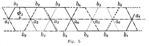
En définitif c'est la ligne en zig-zag  $a_1$   $b_1$   $b_2$ ... formée par les côtés inclinés (anticlinaux) des trapèzes qui est le lieu géométrique indiquant la somme des ordonnées simultanées des 2k+1 courbes dont les demi-ondes ont été représentées par des trapèzes. Or, cette ligne, comme il est facile de s'en rendre compte, par la figure, a 5 (ou bien 2k+1) fois plus de périodes que les courbes qui nous ont servi de points de départ.
