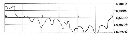
Fig. 7. — Diagramme des corrections provenant de la variation de résistance du fil curseur.
