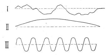
Fig. 5. — Aspect que pourraient prendre les courbes de correction dans les trois cas suivants; I. Défaut d'homogénéité du fil; II. Conicité du tambour; III. Curseur desaxé par rapport au tambour.
