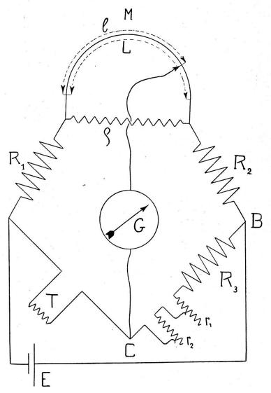
Fig. 8. — Schéma complet du thermomètre électrique à résistance.
