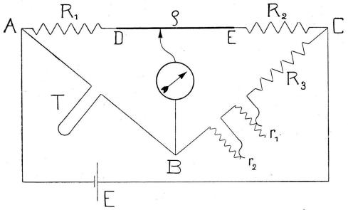
Fig. 1. — Schéma du thermomètre électrique à résistance.
