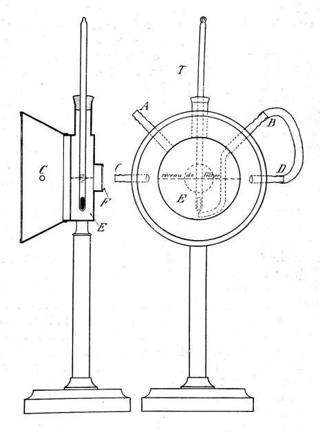
remplissage. C'est par l'ajutage A que se fait l'aspiration de l'air au moyen d'une trompe à eau ou d'un aspirateur quelconque. L'air traverse par conséquent, d'abord la première chambre où s'effectue la condensation et ensuite barbote à travers l'éther. L'observateur suit la marche du refroidissement,
