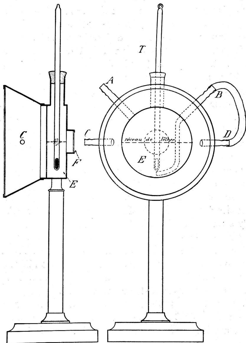
remplissage. C'est par l'ajutage *A* que se fait l'aspiration de l'air au moyen d'une trompe à eau ou d'un aspirateur quelconque. L'air traverse par conséquent, d'abord la première chambre où s'effectue la condensation et ensuite barbote à travers l'éther. L'observateur suit la marche du refroidissement,
