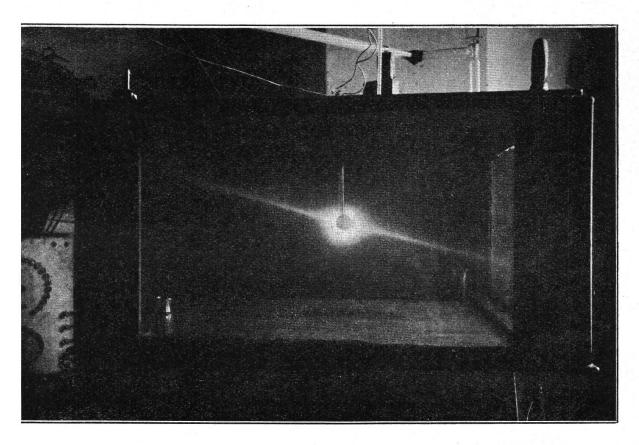
Fig. 2. — Lame de rayons corpusculaires dans le plan de l'équateur magnétique d'une sphère magnétique servant de cathode.
