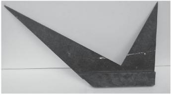
Equerre de menuisier charpentier - équerre pluri angles.
