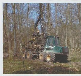
Un porteur, machine centrale pour la production de bois-énergie.
