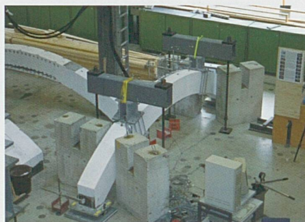
Test effectué à l'EPFL sur une poutre courbe simulant une portion de tunnel avec rupture brutale par éclatement de l'enrobage [1,2]
