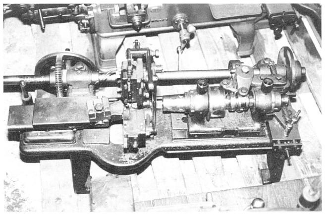
Tour à plateau Mettetal, Junker & C<sup>®</sup>, 1903. Les principaux organes (arbre à cames, poupée mobile) sont disposés de manière analogue au tour Schweizer conçu avant 1880 (photo d'une machine faisant partie du futur Musée du tour automatique de Moutier).
