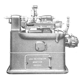
Tour fabriqué par Joseph Pétermann dès 1943, permettant de travailler des barres d'un diamètre allant jusqu'à 10 mm. On distingue les principaux organes de la machine, mais l'entraînement se fait grâce à un moteur individuel, non plus par renvoi. L'installation de tels moteurs sur les tours automatiques s'est répandue depuis le milieu des années 1920 (photo tirée d'un catalogue d'époque).
