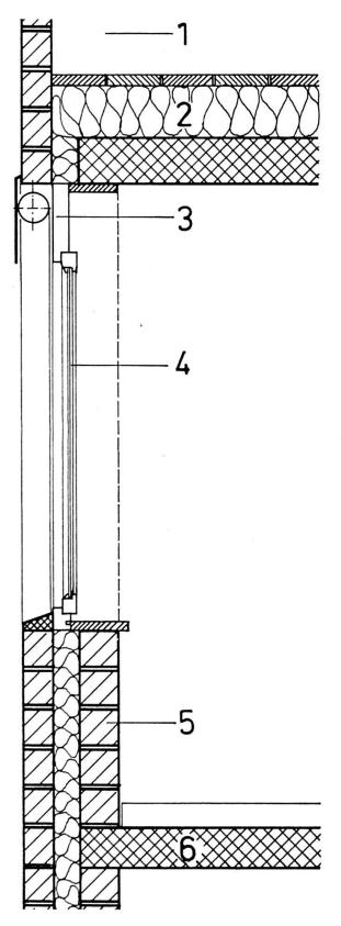
Le point critique (0°) n'est pas à l'intérieur du mur, où il pourrait causer des dégâts en cas d'infiltration d'humidité, mais à l'intérieur de la couche d'isolation.
