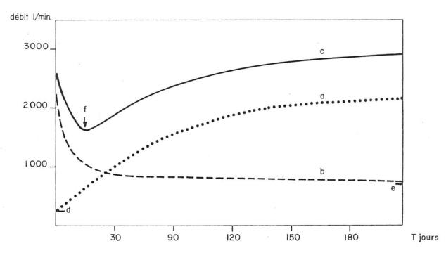
Fig. 1 Rendement d'une source et d'un puits exploités conjointement
