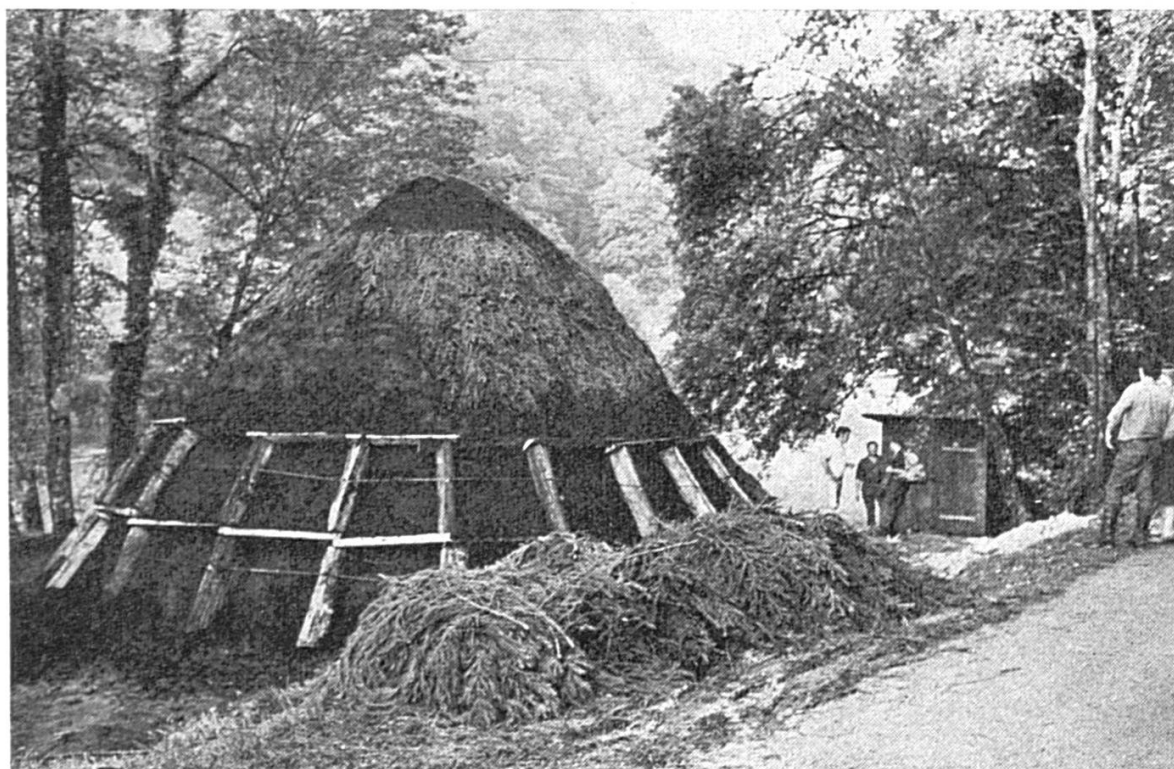
Le poussier est appliqué contre la couverture de branches d'épicéas. A l'arrière-plan, la cabane du charbonnier.
