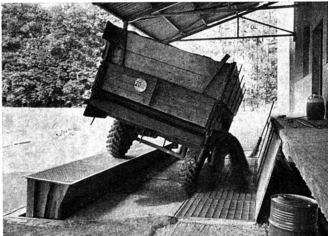
Une des trémies de réception avec pont basculant.
