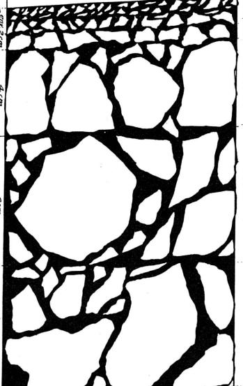
Mortier bitumeux gros Granulométrie 3 - 5 mm. Béton bitumeux fin Granulométrie 5 - 8 mm.
