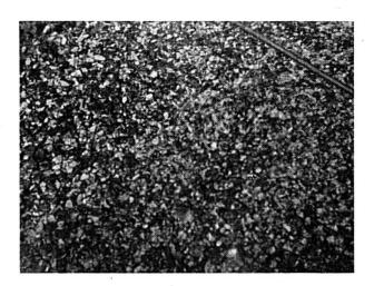
Gravillonnage du « Composol A » 15/25 mm. avant cylindrage
