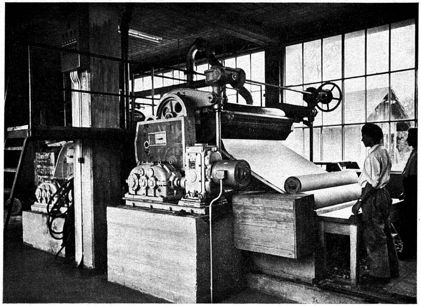
Presse-pâte: A gauche, la pâte entre avec une consistance de 2 % de matière sèche et 98 % d'eau, puis, la pâte, sous forme de feuilles, passe entre les 2 rouleaux d'une presse (partie centrale) et finalement est enroulée dans la partie droite, avec une siccité d'environ 40 %. Le tambour et la presse sont tous deux munis de variateurs PIV
