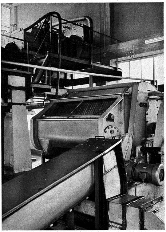
Partie supérieure : trieurs « Jönsson » destinés à éliminer les faisceaux de fibres trop grossiers. — Partie centrale : épaississeur « Lindblad » servant à laver et épaissir la pâte. — Partie inférieure : transporteur à hélices qui conduit la pâte d'une presse à vis cônique au raffineur
