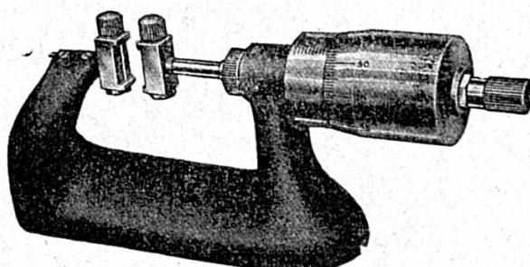
MICROMÈTRE pour mesurer les diamètres
