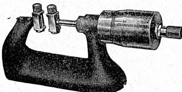
MICROMÈTRE pour mesurer les diamètres
