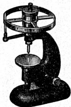
MICROMÈTRE VERTICAL pour mesurages au 1/1000 de mm.
