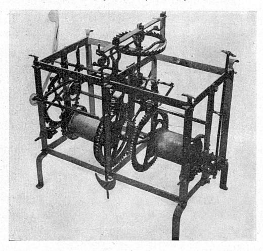
Horloge: mécanisme du mouvement
