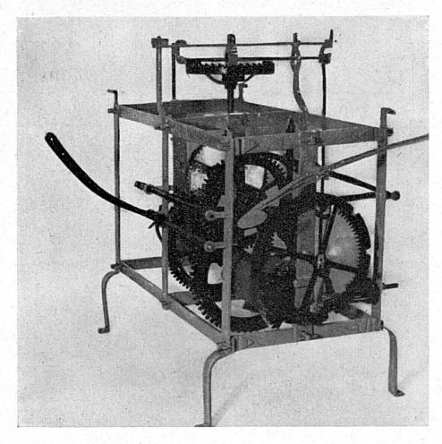
Horloge: mécanisme de la sonnerie
