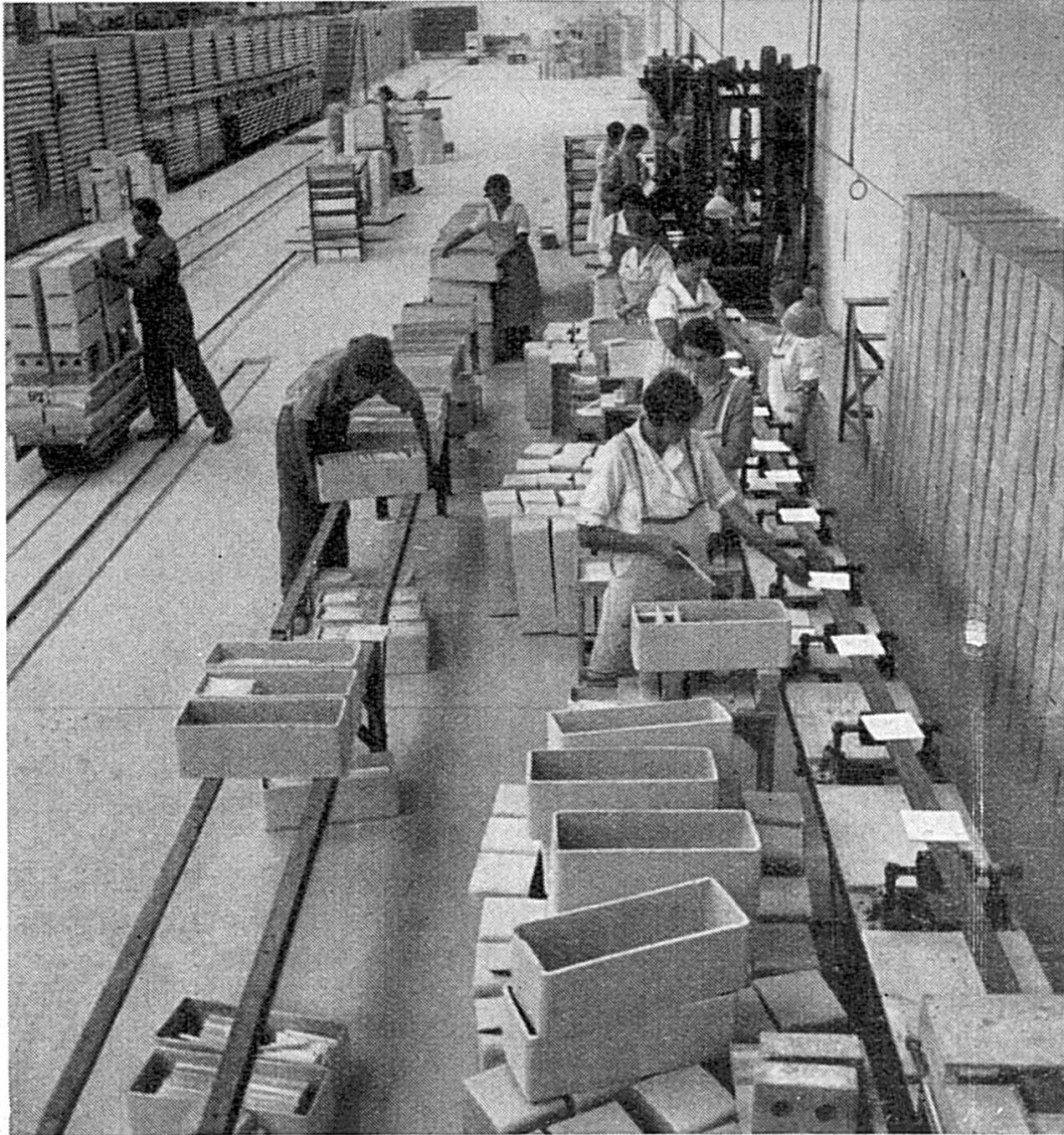
Emaillage des planelles. A gauche, le four-tunnel électrique. Glasieren der Wandplatten. Links, der elektr. Tunnelofen.
