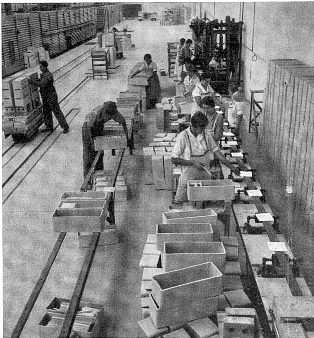
Emaillage des planelles. A gauche, le four-tunnel électrique.
