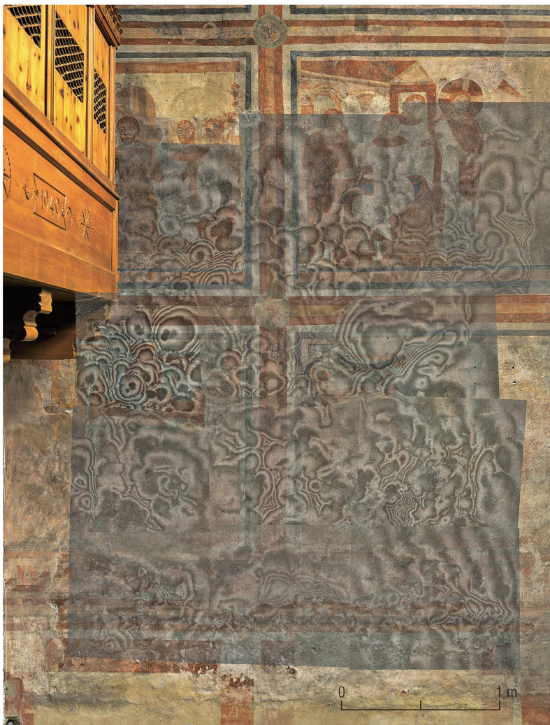
Abb. 3: Val Müstair. Müstair. 2022. Klosterkirche. DHSPI-Kartierung der Untersuchungsfläche. Die Interferenzmuster geben Hinweise auf Diskontinuitäten und Hohlräume unterhalb der Oberfläche.
