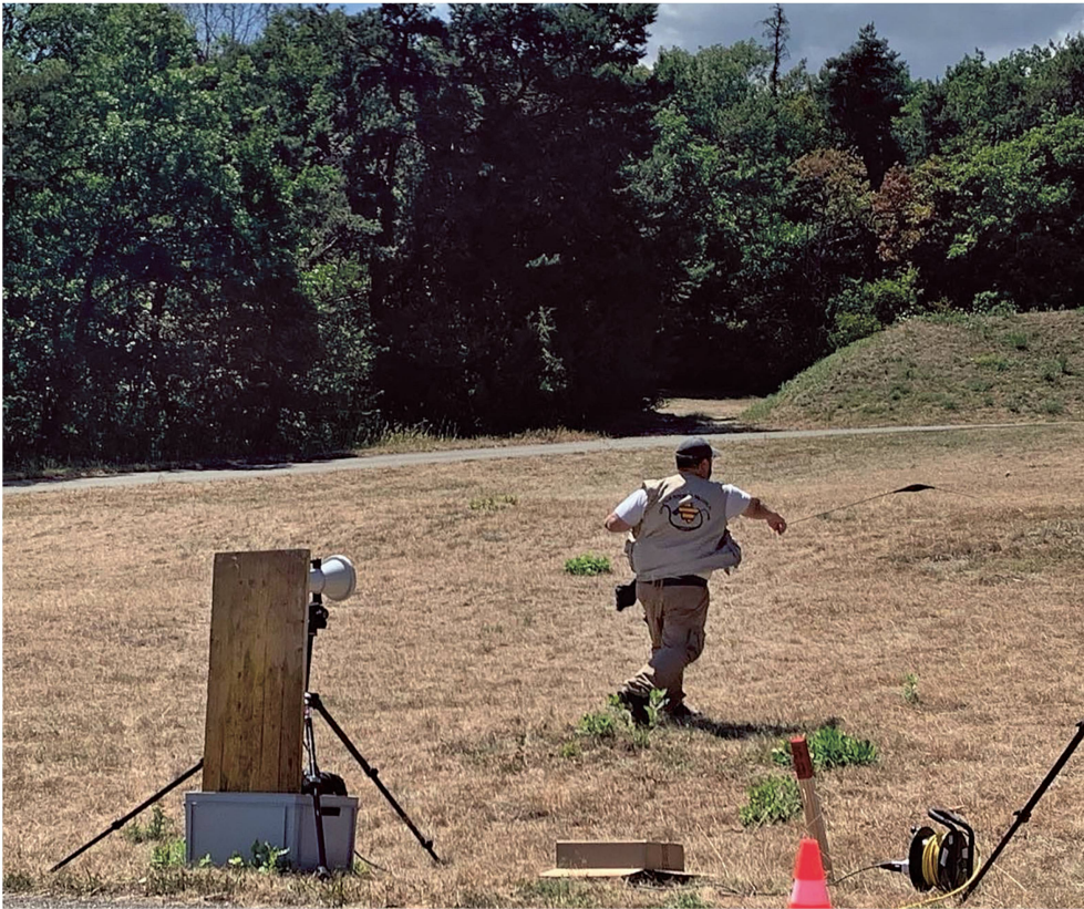
Abb. 11: Bretonnières VD. 2022. Silvio Vass, Celle (D), schießt mit seiner balearischen Schleuder auf ein Ziel. Dabei wird sein Schuss mit einem Dopplerradar vollständig vermessen.
