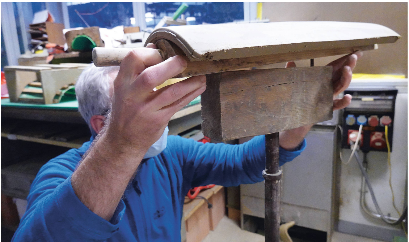
Abb. 5: Rapperswil BE, Ziegelwerk Gasser Ceramic AG. 2022. Für das einfachere Arbeiten sind die Holzleisten drehbar auf Ständern montiert.
