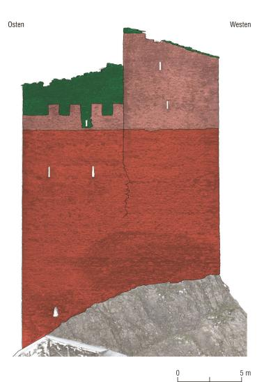
**Abb. 2:** Chur. Haldenstein, Burganlage Haldenstein. 2020/2021. Palas und Turm, Nordfassade, Baualtersplan. **Phase I** (1192–1200): Etappe 1: rot, Etappe 2: hellrot; **Phase II** (um 1376): grün. In **Phase I** zeichnet sich das Horizontallimit bei 714 m ü. M. deutlich ab. Mst. 1:200.
