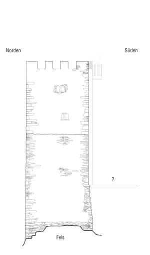
**Abb. 3:** Chur. Haldenstein, Burganlage Haldenstein. 2020/2021. Turm, Südwestfassade, Rekonstruktion **Phase I** (1192–1200). Mst. 1:200.
