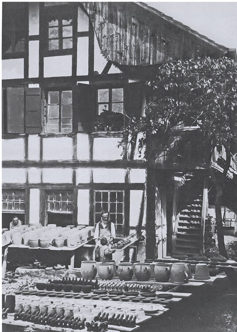
Abb. 8: Heimberg BE, 1917. Vor der Töpferei Reusser im Schulgässli trocknen Figuren, Tassen, Untertassen, Töpfe und schüsselförmige Deckel in der Sonne.
