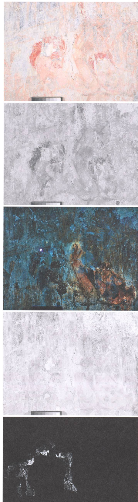
Abb. 5: Val Müstair. Kloster St. Johann in Müstair, Heiligkreuzkapelle. Multispektralaufnahmen eines Bereiches der karolingischen Wandmalereien an der Nordwand des Obergeschosses. Von oben nach unten: sichtbares Licht, UV-Reflexion, UV-Fluoreszenz, Infrarot-Reflektographie und Infrarot-Lumineszenz. Letztere hat es ermöglicht, die mit bloßem Auge nicht mehr erkennbaren Malereien in Ägyptisch Blau sichtbar zu machen. Länge des Graukeiles: 9 cm.
