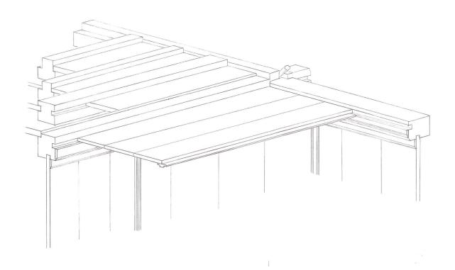
Die südlichen Kopfrähme sind stumpf gegeneinander gesetzt und mit eigenem Ausschnitt auf das Blatt des Kopfrähms der Trennwand aufgelegt. Zuletzt mussten sie noch mit einem Zapfen verspriesst werden.
