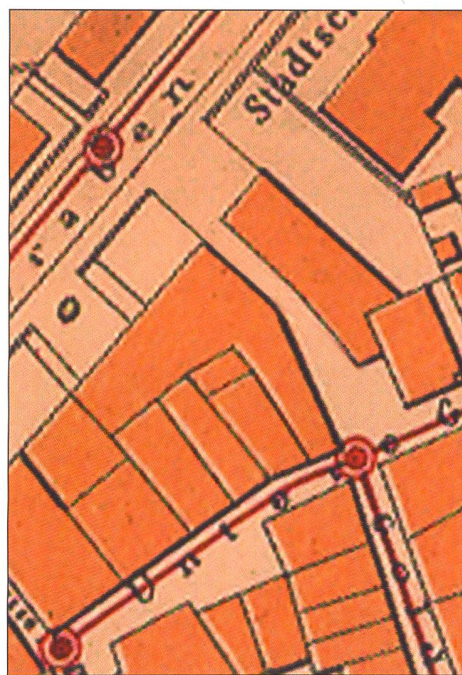
Abb. 76: Chur, Goldgasse/Grabenstrasse. Ausschnitt des Stadtplans von Ernst Karl Münster aus dem Jahr 1876, nachgeführt von Emil Blumer im Jahr 1891. Mit roter Farbe eingezeichnet ein erst 1907 ausgeführtes Kanalisationsprojekt aus dem Jahr 1889. Mst. 1:1000.
