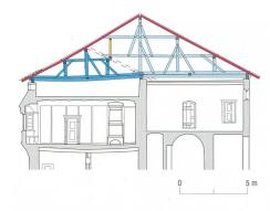
Abb. 58: Val Müstair, Müstair, Kloster St. Johann. Norperttrakt, Dachstühle von 1642 (blau) und 1647 (hellblau) sowie Hilfsstützen (gelb) und Rafen (rot). Planmontage einer Binderebene mit dem Schnitt durch das Fürstenzimmer. Ansicht gegen Norden. Mst. 1:300.
