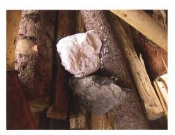
Abb. 124: Kalkkurs in Sent. Kalkgestein (grau) und gebrannter Kalk (weiss).
