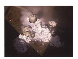
Abb. 123: Kalkkurs in Sent. Löschen des Kalks.
