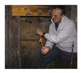
Abb. 6: Trivun Sormaz, der neue Mitarbeiter im Dendrolabor, bei der Entnahme einer Bohrprobe im Haus Nr. 120 in Avers, Cresta.
