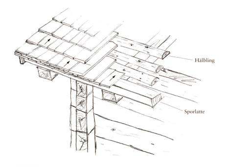
der zweiten Reihe werden die Stossfugen der ersten Reihe, mit der dritten Reihe die Stossfugen der zweiten Reihe gedeckt (Abb. 90). Besondere Aufmerksamkeit ist den Randdetails (Abb. 91) sowie der Kehl- und Gratausbildung zu schenken (Abb. 92). Sehr anspruchsvoll ist die Ausführung komplizierter Formen, wie sie z. B. bei ei-
