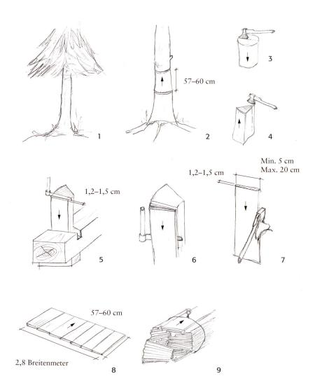
Abb. 89: Die einzelnen Schritte bei der Schindelherstellung.
