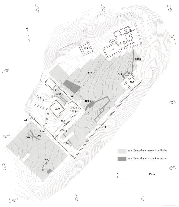
eckigen Bauten könnte es sich bei den Strukturen Pos. 1014 handeln. Anhand einer Sondierung konnte die im Radar erfasste Struktur sicher als Mauer Pos. 711 angesprochen werden. Diese biegt nach etwa 6 m nach Nordosten ab. Auf einer Länge von ca. 12 m Länge liegt sie parallel zur Umfassungsmauer und bildet dann mit weiteren Mauern ein Geviert, bei dem es sich um den Treppenabgang in tiefer gelegene Räume handeln kann. Der weitere Verlauf dieser Mauer entzieht sich einer schlüssigen Deutung.
