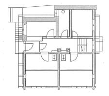
Abb. 156: Gebäudeinventar. Lumbrein, Haus Nr. 111. Grundriss Erdgeschoss. Der Plan lässt deutlich zwei unterschiedliche Konstruktionsweisen erkennen: Zwei Strickkuben liegen vor einem Mittelkorridor, welcher diese und die teilweise noch im Mauerwerk sitzenden rückwärtigen Räume (Küche und ehemaliger Vorratsraum) erschliesst. Mst. 1:250.
